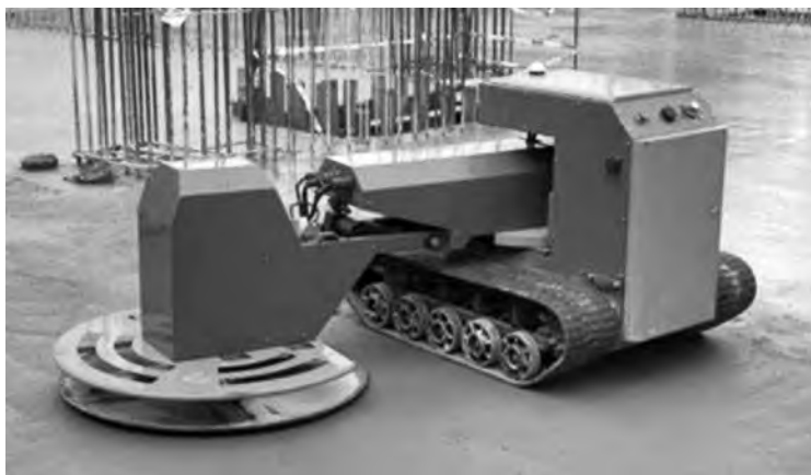
图 3-18 混凝土施工机器人
