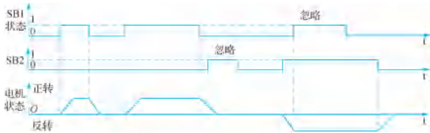
图 3-1-7 二线制控制方式 2 的电机运行效果图
