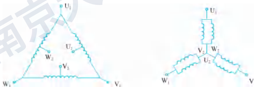
图 1-2-5 4/2 极双速电动机定子绕组接线图
