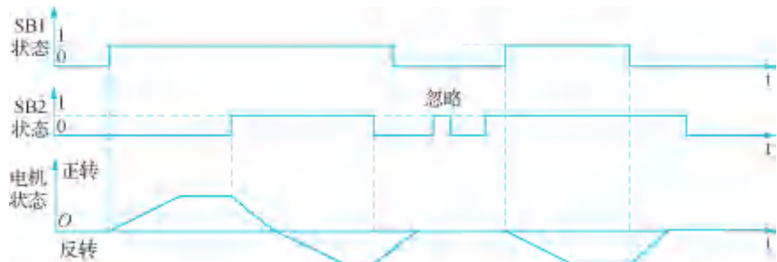
图 3-1-6 二线制控制方式 1 的电机运行效果图
