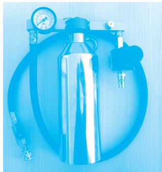
图 3-26 燃油系统清洗吊瓶
