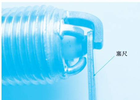
图3-40 火花塞电极间隙检查
