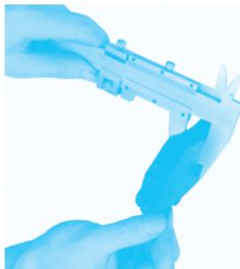
图 4-43 检查制动块厚度
