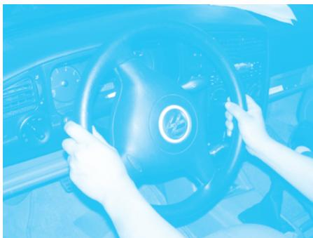
图 4-68 方向盘游隙检查
