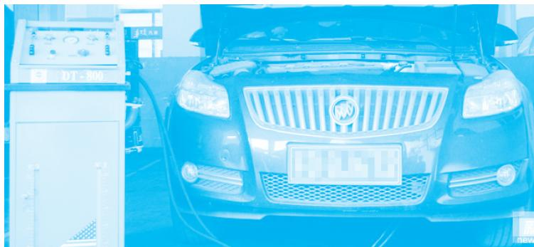
图 4-7 自动变速器免解体维护
