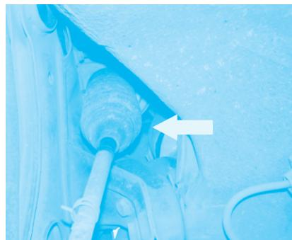
图 4-69 转向杆保护罩检查
