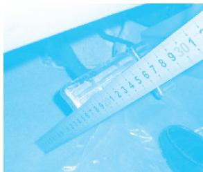
(a) 测量制动踏板高度
