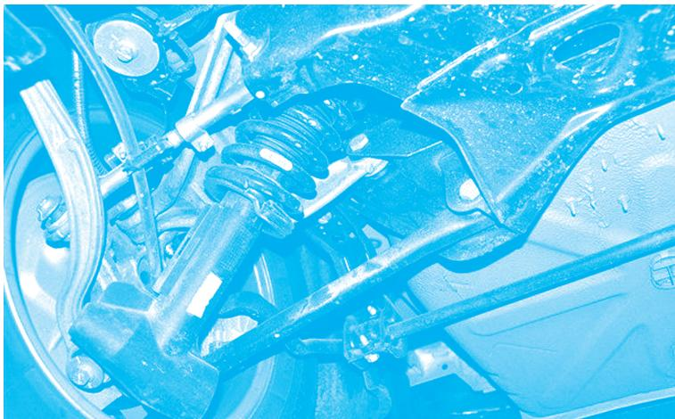
图 4-82 汽车减振器安装位置图
