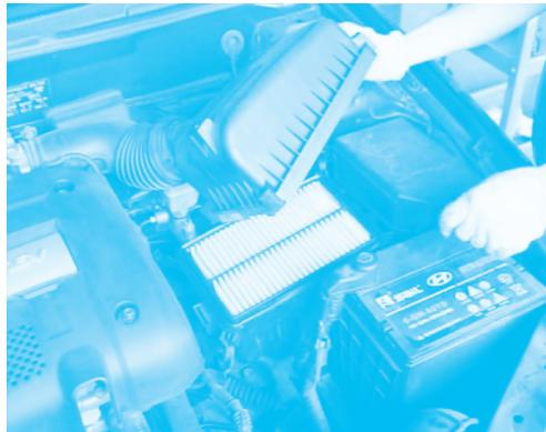
图 3-15 空气滤清器的正确安装
