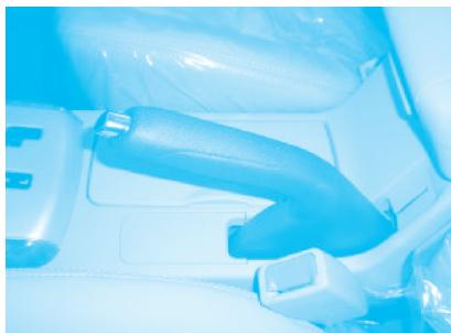
图 4-33 驻车制动器的基本检查
