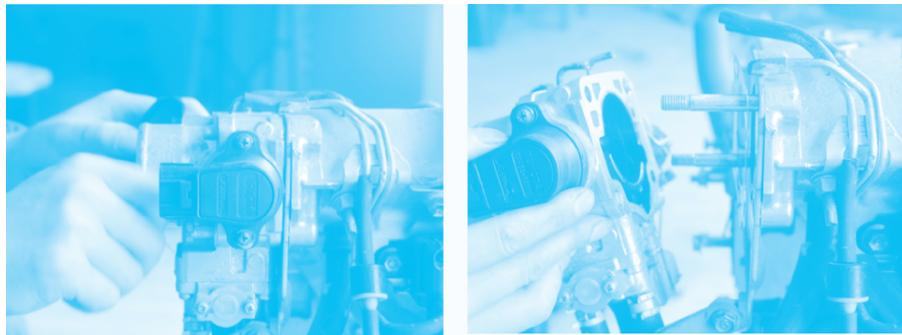
图 3-18 拆卸节气门体
