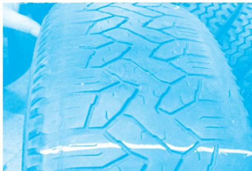
图 4-11 轮胎外侧边缘磨损
