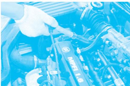
图 3-38 拆卸高压分电线
