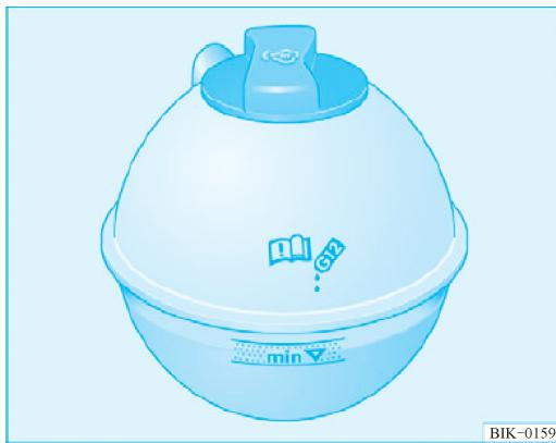
图 1-9 检查冷却液液面高度
