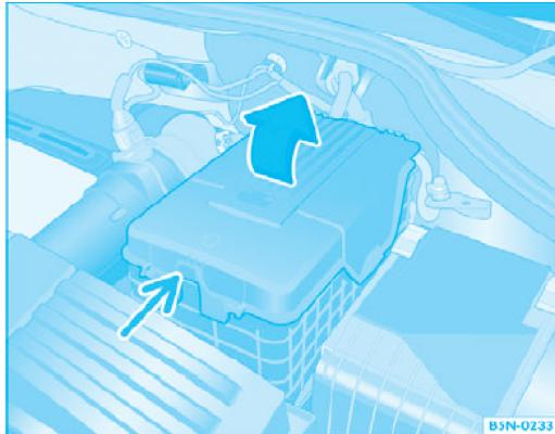
图 1-11 拆卸蓄电池护盖
