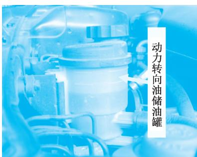
图 4-74 检查转向油液面高度
