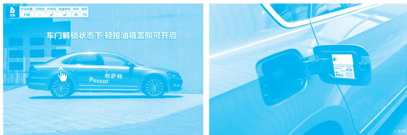
图 1-14 燃油箱盖开启开关
