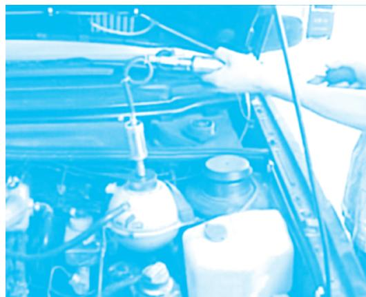
图3-22 冷却系统泄漏检测
