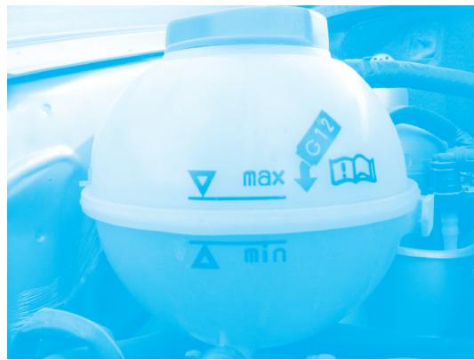
图 3-19 检查冷却液液位
