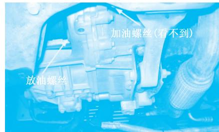
图 4-2 手动变速器齿轮油的更换
