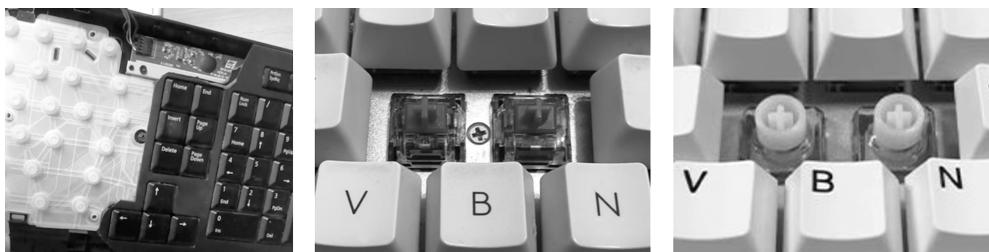
图 1-2-8 薄膜、机械、静电容键盘
