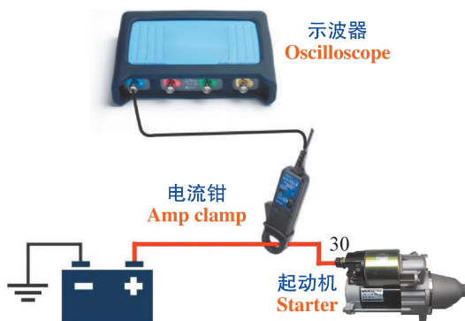
图 3-40 起动电流波形测试
