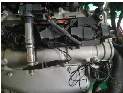
图 4-34 独立点火线圈的跳火试验
