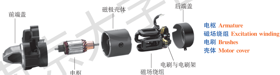
图 3-4 直流电动机结构图
