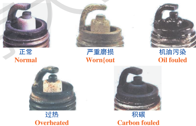
图 4-13 火花塞的损坏情况
