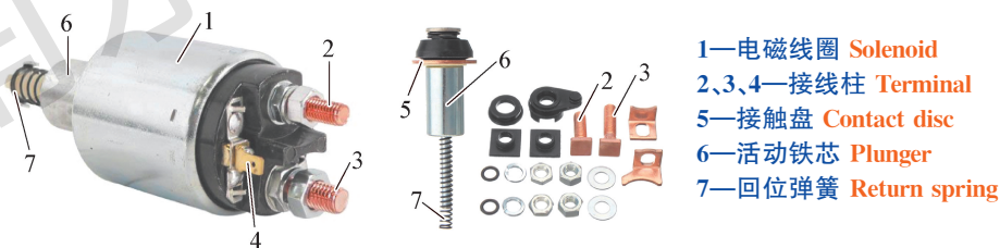
图 3-14 电磁开关结构图
