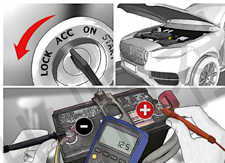
图 2-7 蓄电池静态电压测量
