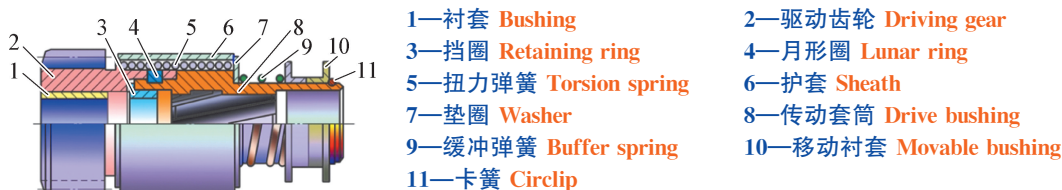
图 3-12 弹簧式单向离合器
