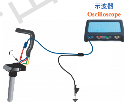
图 4-27 点火信号波形测试
