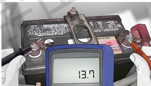
图 2-29 发动机起动机时电压测试
