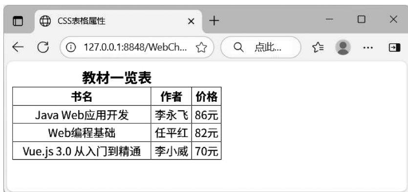
图 3-14 应用 border-collapse 属性
