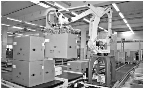
图 2-28 工业机器人搬运码垛系统
