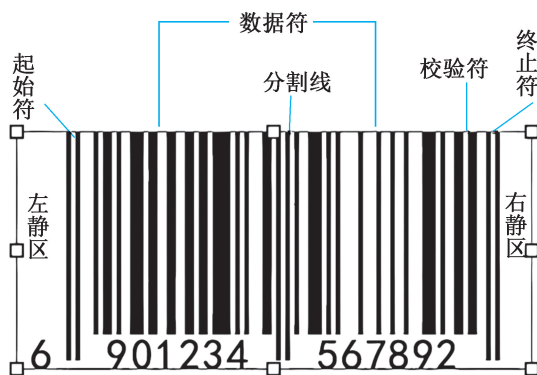
图 1-1 一维条码的结构
