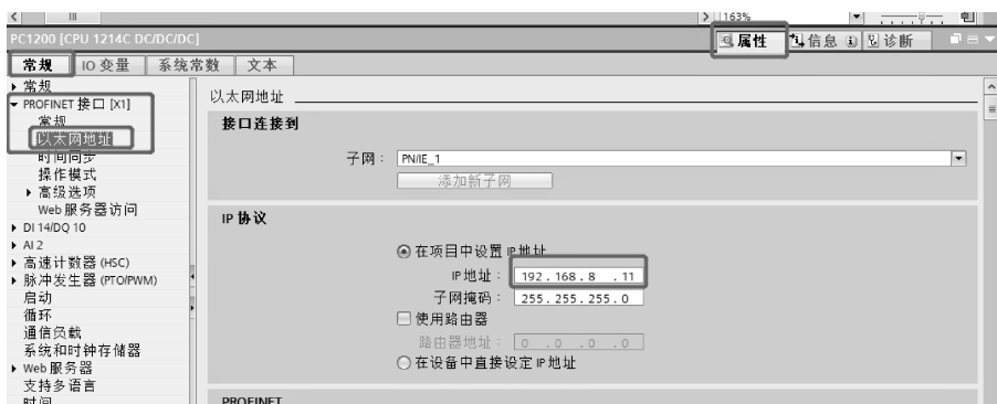
图 1-16 修改 IP 地址
