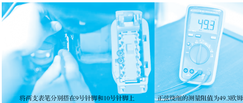
图 1-77 正弦绕组阻值测量
