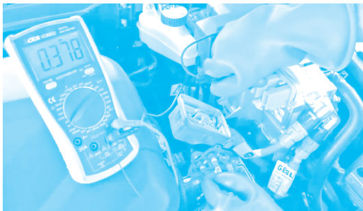
图 1-65 万用表负极接高压母线端子正极,正极分别接 U、V、W 三相
