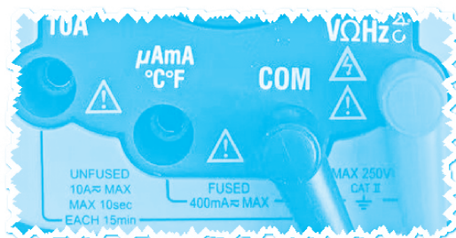
图 2-13 万用表电压挡接线图
