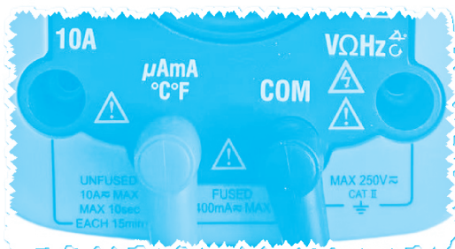
图 2-43 万用表电流挡接线图
