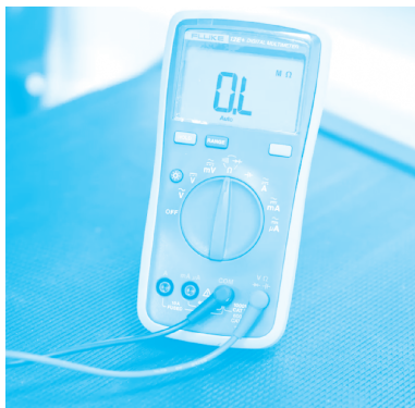
图 1-75 万用表自适应电阻挡位
