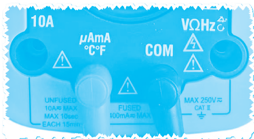
图 2-14 万用表电流挡接线图
