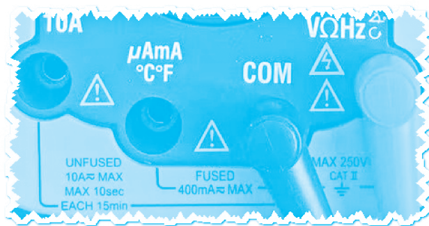
图 2-28 万用表电压挡接线图
