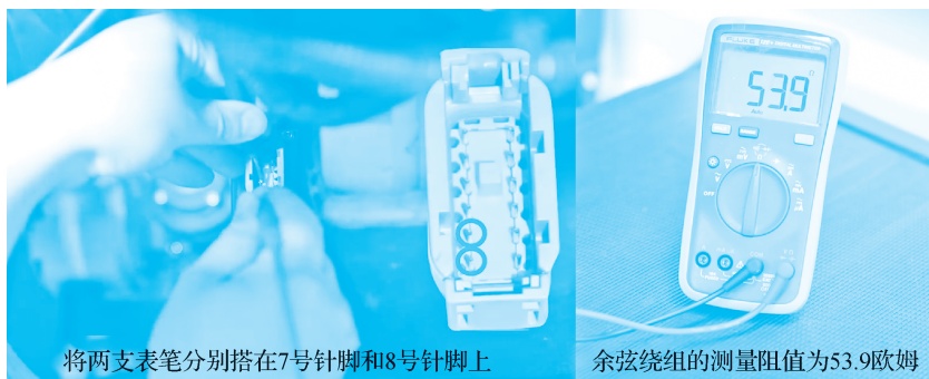
图 1-76 余弦绕组阻值测量
