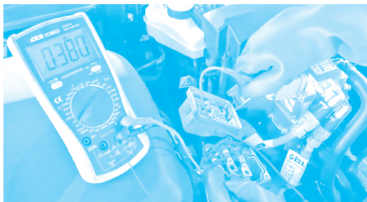
图 1-66 万用表正极接高压母线端子负极,负极分别接 U、V、W 三相
