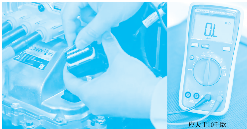
图 1-79 导线短路测量
