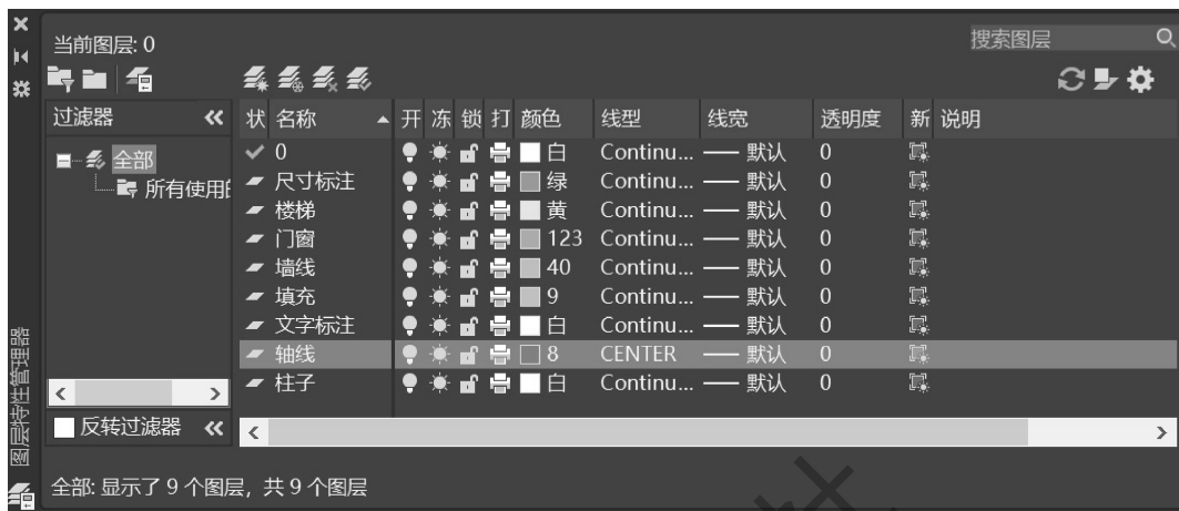
图 3-12 轴线图层的线型加载为 CENTER
