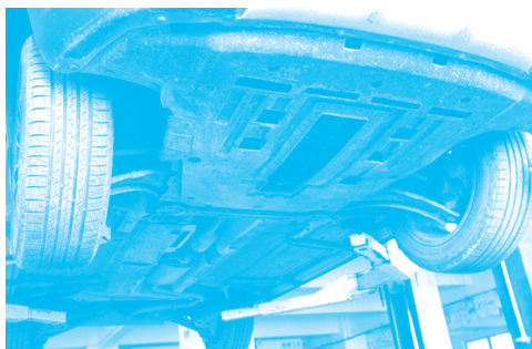
图 3-23 检查底盘线束和元件有无损伤
