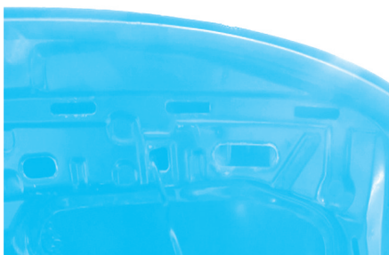
图 3-28 检查发动机舱盖散热孔和钣金胶
