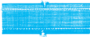
(b) 安全带边缘割断松散(由车门引起的损坏)
