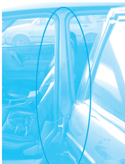
图 3-15 B 柱位置检查
