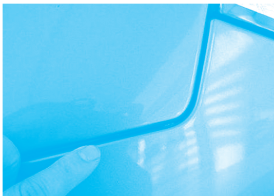
图 3-22 车身接缝有二次喷漆的痕迹
