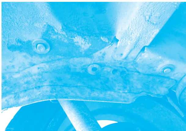
图 3-43 左后部底盘骨架锈蚀
