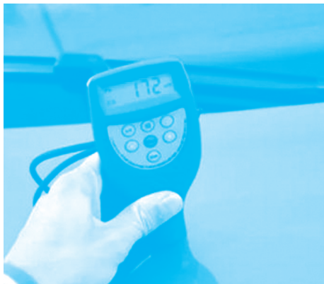
图 3-21 用漆面厚度仪检查是否打过腻子
