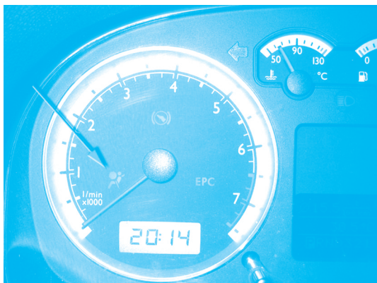
图 3-37 安全气囊 SRS 指示灯检查
