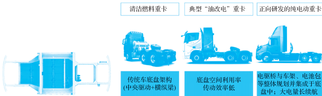
图 1-12 轻型商用车滑板底盘平台、重型商用车纯电平台发展
