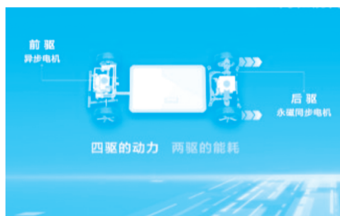
图 2-9 高性能四驱架构
