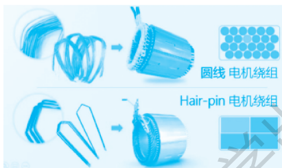
图 2-21 特斯拉采用扁线电机功率密度高,体积小
