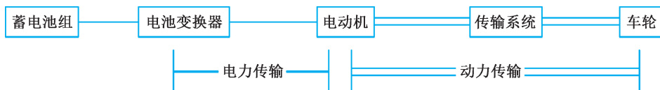
图 2-2 用单一蓄电池作为动力源的纯电动汽车的电力和动力传输系统
