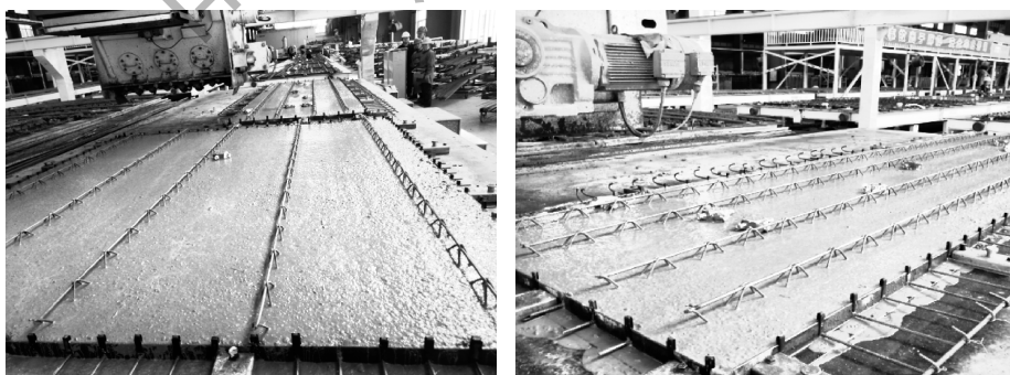
图2-2 叠合板浇筑与振捣
