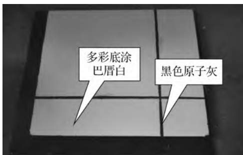
图 2-15 构件表面喷涂底漆
