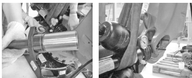
(a) 安装支承销装入工装
