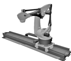
(a) 地面安装
