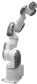
(b) MOTOMAN-IA20 7轴臂型机器人
