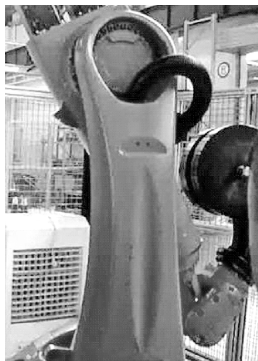
图1-3-7 平衡缸保养时机器人姿态
