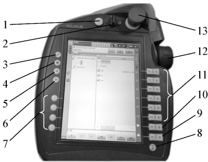
1—解锁按钮 2—连接管理器开关 3—键盘显示按钮 4—停止键 5—逆向启动键 6—正向启动键 7—状态键 8—主菜单按钮 9—手动倍率按钮 10—程序倍率按钮 11—移动键 12—3D 鼠标 13—急停按钮
